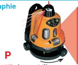
P 3040ME - Laser rotatif - Plan horizontal / vertical + équerrage - Portée : rotation : 10m de rayon - 0 à 350 trs/min scan : 20m de rayon - ±3 mm à 10m point : 30m de rayon cellule : > 60m de rayon - Inclinaison sur axe de 4° / Graduation 0,1% - Livré support mural et support pour trépied - Trépied, cellule laser et mire en option - D : 200x150x150mm / 5,5kg / Pile : 4xAAA
