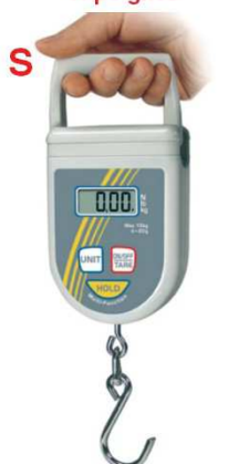
S Portée Lecture 2150KE 15 kg 20 g 2151KE 50 kg 50 g - Fonctions Tare, Hold, Auto off - Sélection Newton / kg - D : 90x30x175mm / 300g - Chiffres : 11mm - Pile : 9V
