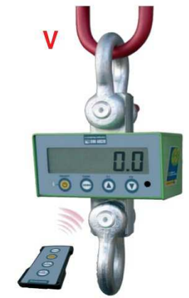
V Portée Précision (en kg) 263PM 1500/3000/6000 0,5/1/2 } selon 264PM 3000/6000/9500 1/2/5 } portée - 3 plages de mesures et précisions différentes - Fonction Tare, Hold, Auto off - Chiffres 25mm - Accu interne - Adaptateur 220V - D : 410x170x130mm / 10 kg - Télécommande (2xAAA) - Pile : 9V
