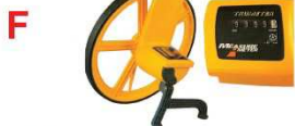
F 1500TR - Mécanique - Capacité 10 000 m - Mesure en cm ou dm - Précision ± 1 % - Addition / soustraction - Bouton de RAZ - Ecran 13x6,5 mm - Étanche à la pluie - Roue caoutchouc Ø 32 cm) - Béquille rétractable - Hauteur : 1,15 m / 1,5 kg - Ecran : 13x6,5 mm
