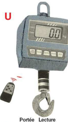
U Portée Lecture 1003KE 60 kg 20 g 1010KE 150 kg 50 g 1032KE 300 kg 100 g 1050KE 600 kg 200 g - Fonction Tare, Hold, Auto off - Chiffres 13mm - Accu interne - Adaptateur 220V - D : 150x140x155mm / 4kg - Télécommande (2xAAA) - Piles : 2xAAA
