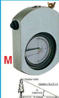
M 5000ME - Clinomètre en degré - Tambour pendulaire à huile - Division : ±90° / +150° - Table des cosinus 0-45°
