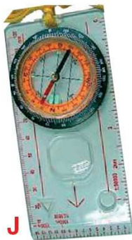
455LA - 1 er prix Capsule rotative - Ø 60mm / Préc. 2° - Aiguille montée sur saphir Règle graduée 10cm - Loupe de carte - Echelle 1:50 000 / 1:25 000 - Gabarits O et Δ - D : 130x60mm pliée / 60g
