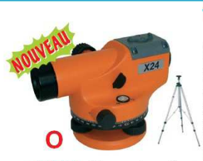
O 5900WI - Niveau de optique - Grossissement 24x / Ouverture 36mm - Visée min 0,5m / Préc.±2,5mm - Viseur optique - Cercle gradué 400 grades - Filetage 5/8" - Livré avec coffret ABS + mire 4m + trépied + nivelle
