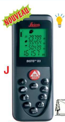
J 2610ME - Laser - Portée 100m / Préc. ± 1mm - Mesure mini 5cm - Fonctions : clinomètre, pythagore, angulaire, distance, surface, volume - Addition / Soustraction - Affichage 20 dernières mesures - Arrêt auto après 3 min - Rétro éclairage - Étanche IP54 - Arrêt auto après 3min - D : 125x45x24mm / 110g - Piles : 2xAAA (fournies)
