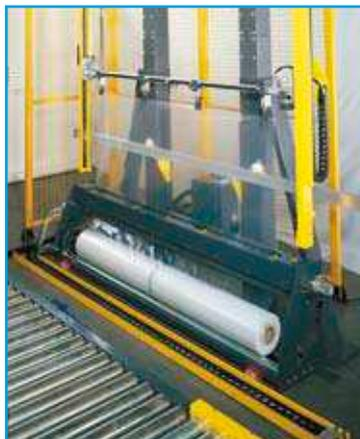
En option : dépose automatique de coiffes polyéthylène
