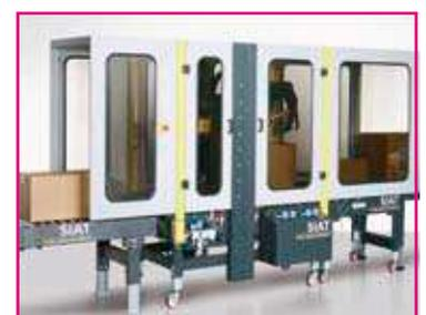
Dispositif de protection métallique avec porte d'accès et coupe circuit
