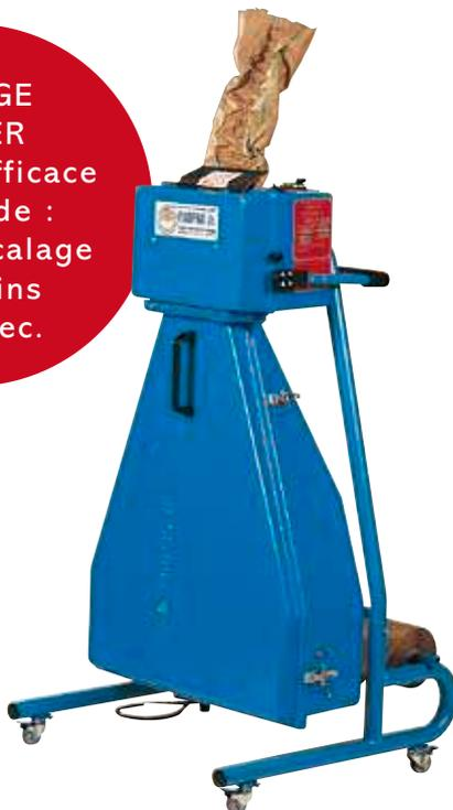
Le froissage et le pliage de feuilles de kraft par une machine mise à votre disposition. Polyvalent et super protecteur, PadPak comble les vides, enveloppe, fixe et cale en amortissant les chocs.
