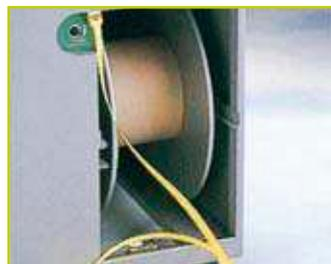
Ejection automatique du feuillard en fin de bobine
