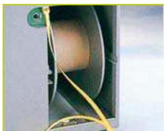
Ejection automatique du feuillard en fin de bobine
