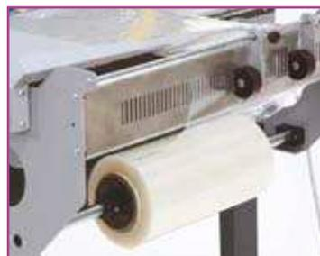
Dispositif de micro perforation du film facile d'utilisation
