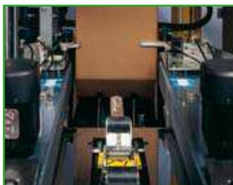
Butées tournantes pneumatiques, contrôlés individuellement, pour équerrage des caisses
