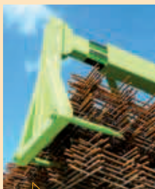
Doigts de préhension usinés en pointe
