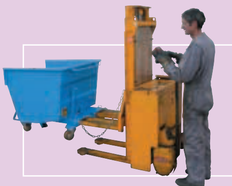
Fourreaux spéciaux prise Gerbeur
