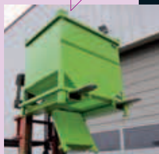
Vidage par trappe inférieure
