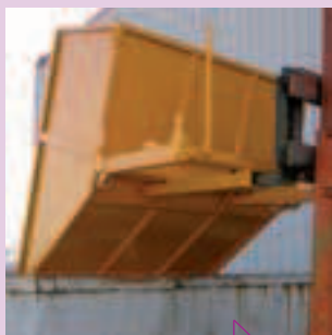
Basculement dans collecteur
