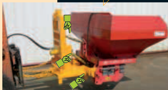
Attelage trois points Branchement prise de force
