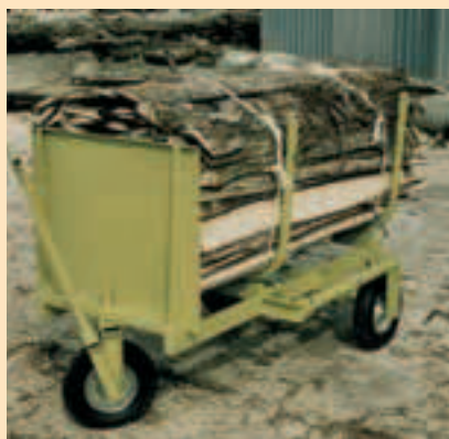
Roues protégées (encastrées sous châssis)
